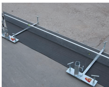
7. A nivelláló készletre helyezett libellás lehúzóléc
